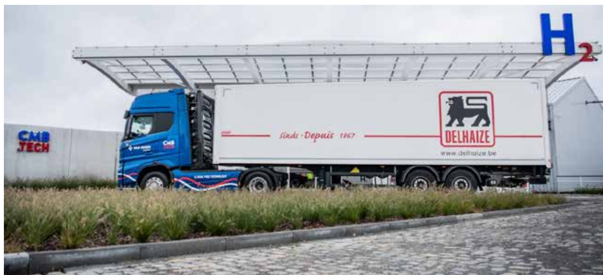
Figuur 17: Vrachtwagen (40 ton) met dual-motor in demonstratie Van Moer Logistics/Delhaize
