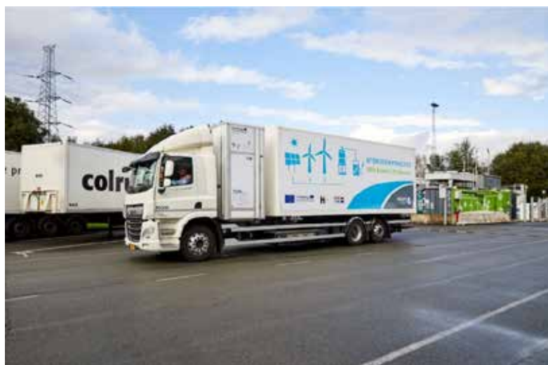
Figuur 16: Bakwagen (27 ton) met brandstofcel in demonstratie bij Colruyt Group
