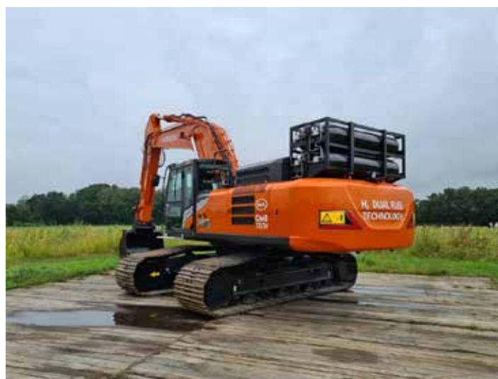
Figuur 19: Graafmachine met dual-fuel motor op waterstof van CMB/Luyckx
