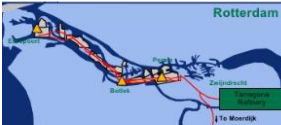
Figuur 4.6: Bestaand 140 km leidingnet voor waterstof van Air Products
