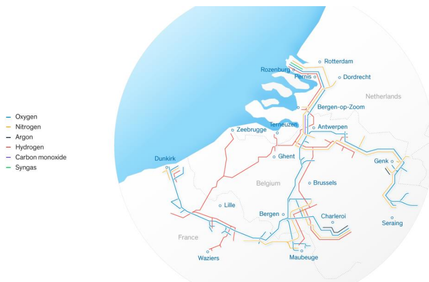
Figuur 4.5: Bestaand 900 km leidingnetwerk voor waterstof van Air Liquide
