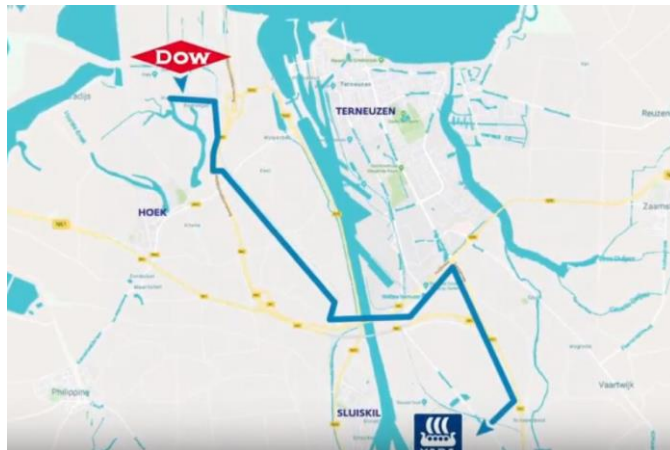
Figuur 4.8: 12 km omgebouwde aardgasleiding naar waterstofleiding
